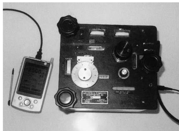
Obr. 4 Gravimetr LCR 1068 G spolu s PDA Fujitsu – Siemens L00X 610 při měření
