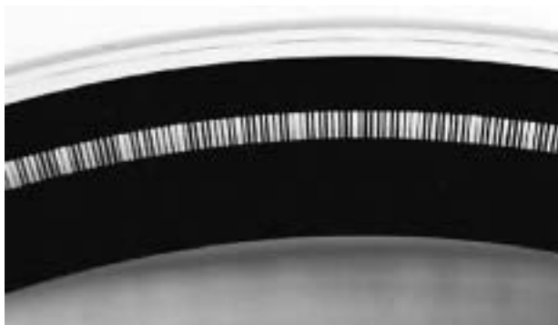
Obr. 2 Kódovaný skleněný kruh (Leica)
