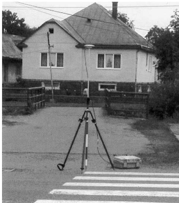
Obr. 1 Meranie vŕtovacieho bodu metódou GPS
