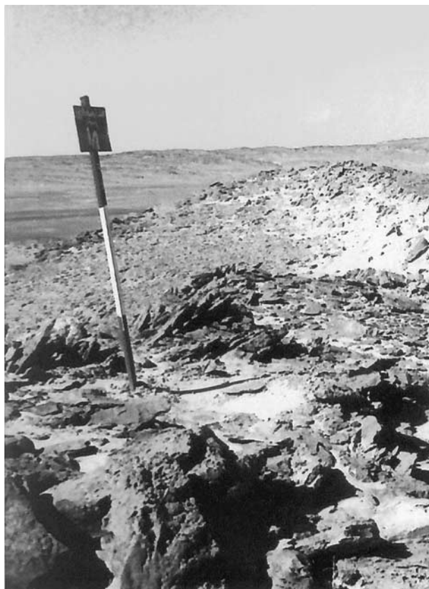
Obr. 2 Stabilizace pro výšková a polohová měření bodu v poušti (bod umístěn vpravo od tyče, svrchní částí splyvajícím s terémem)
