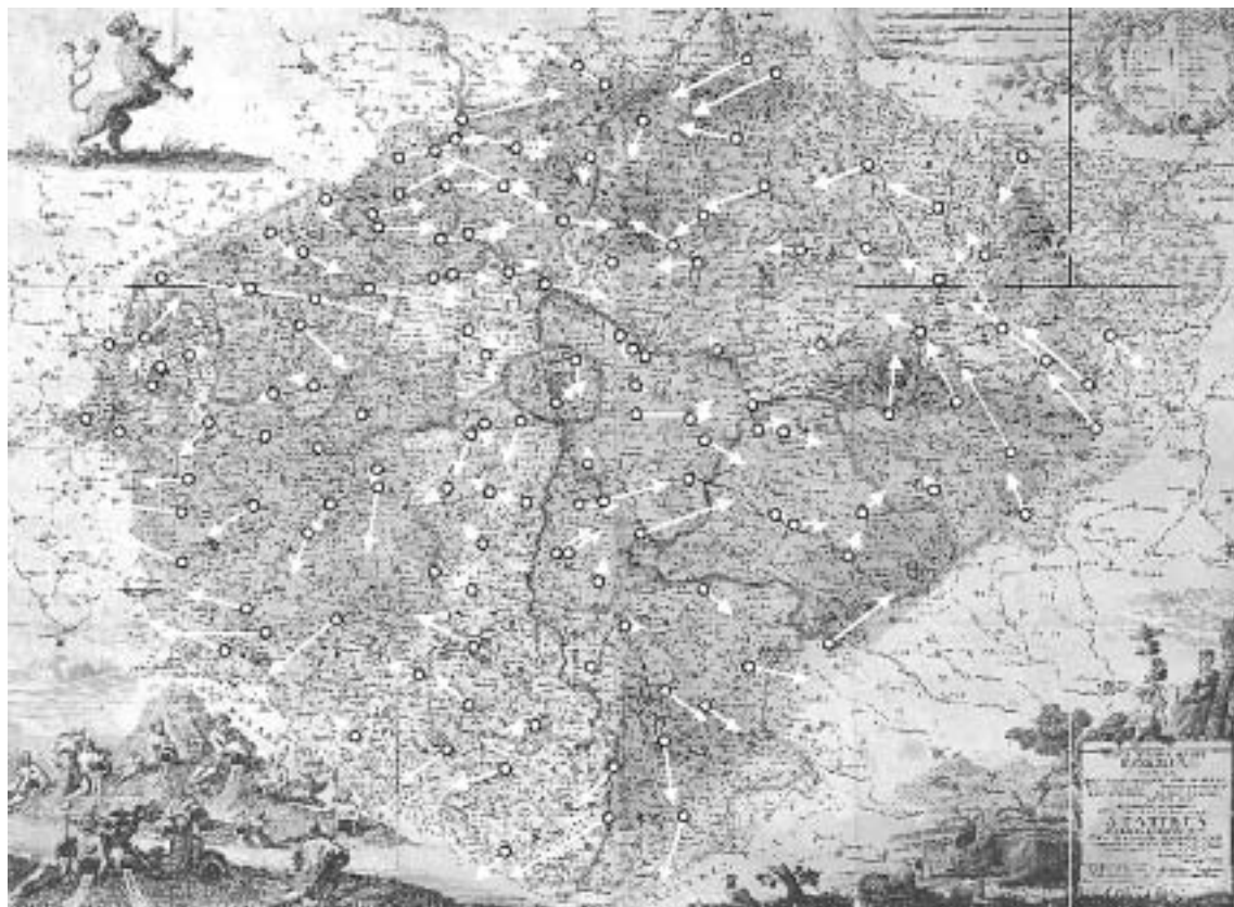
Obr. 3 Polohové odchylky na 137 identických bodech znázorněné v měřítku 2:1
