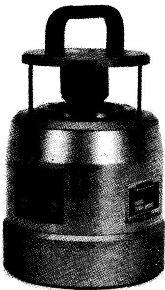
Obr. 3 Diodový laser AS 21 pro vytváření vodorovné nebo svíslé roviny
