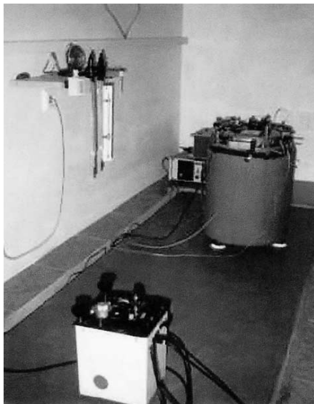
Obr. 4 Slapová stanice GO Pecný, slapový gravimetr ASK 228 – vzdálenější
